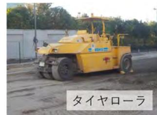
【タイヤローラ】ローラがゴムでできた締固め機械です。締固めが容易な普通土や、舗装路盤の碎石等に適しています。また、アスファルト合材の転圧にも用いられます。
