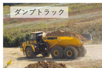
【ダンプトラック】土砂・岩石等の運搬専用車両で、荷台を傾斜させて排土（ダンプ）できるものをダンプトラックと呼びます。多くの場合、油圧ショベルやホイールローダと組み合せて使われます。
