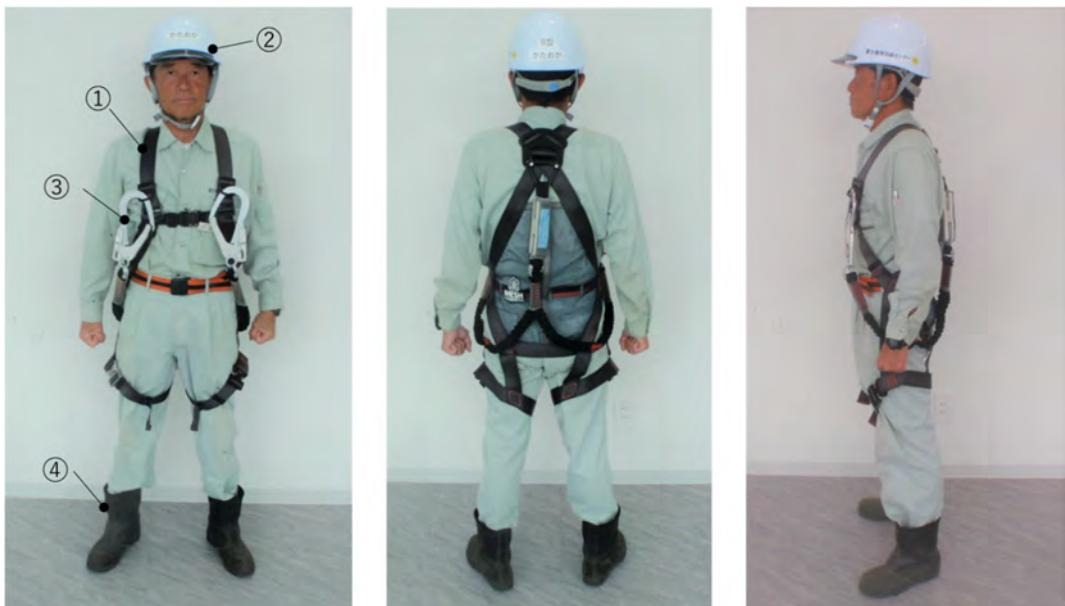
【フルハーネス型墜落制止用器具】フルハーネス型墜落制止用器具は、墜落を制止するための器具です。2022年1月2日からは、作業床の高さが6.75mを超える場合は、装着することが義務付けられました。ただし、墜落事故の多い建設業については、5mを超える高さの作業でも、フルハーネス型墜落制止用器具の使用が求められています。
