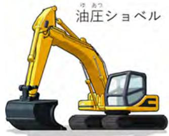
【掘削作業】土砂や岩石を掘って取り除く作業を「掘削作業」と言います。火薬類を使って岩石などを破壊することもあり、これを「発破」と言います。建物の基礎は地面の下に埋めます。このために地面を掘ることを、「根切り」と言います。
