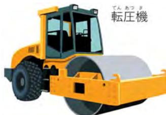
【ロードローラ】ローラが鉄でできた締固め機械です。舗装工事において、路床や路盤の締固めなどに用いられます。
