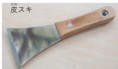
【皮スキ】もとは皮を薄くするための道具ですが、鋭い刃があるため、塗装工事における「ケレン作業」にも用いられます。
