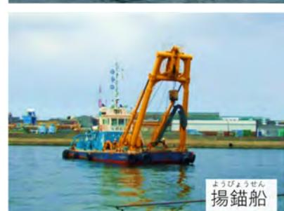
**【揚錨船】** 船の上についているウインチを使って、他の作業船の錨(アンカー)を巻き上げたり、海に投込んだりするための作業船です。
