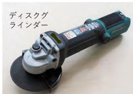
【ディスクグラインダー】先端に取り付けるディスク（円形で平たい形の研磨および切断用の砥石）を交換することで、金属管やコンクリートの切断や研磨、塗装を剥がすことができる電動工具です。金属の切断には高速トルク型が、研磨には低速トルク型が向いています。
