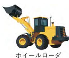
【ホイールローダ】車体前方に大型のバケットを持つ車輪で走行する、積み込みおよび運搬用機械です。車体の前進とバケット、ブームの動作により、土砂、採石等の各種材料をすくい上げてダンプトラックなどに積み込みます。
