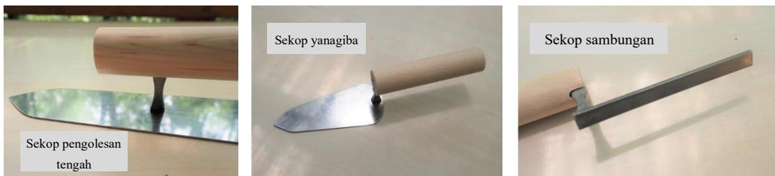
**[Pelat sekop]** Dudukan tempat material plesteran, mortar, dll. ditempatkan. Pekerjaan dilakukan dengan satu tangan.
