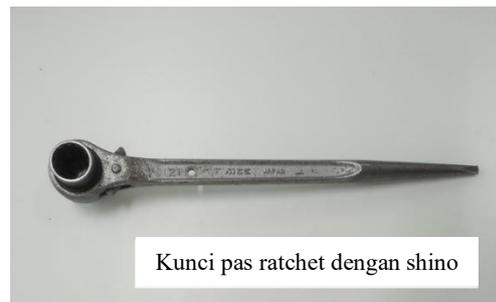
untuk mengencangkan bansen, dll. Bagian yang runcing disebut “shino”. Bagian lainnya berlubang sehingga memungkinkan untuk mengencangkan dan mengendurkan baut. Alat ini digunakan dalam pekerjaan perancah dan pekerjaan rebar. Ukuran yang digunakan dalam pekerjaan perancah terutama adalah ukuran 17 x 21 mm.
