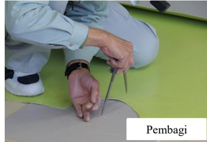
**[Pembagi]** Mirip dengan jangka, tetapi dengan jarum di kedua kakinya. Digunakan untuk memindahkan panjang yang sama ke bagian atau material lain.
