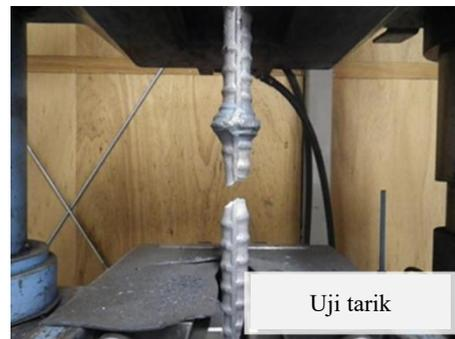
sepenuhnya, sambungan tidak dapat dibedakan, dan saat dilakukan uji tarik atau uji tekuk, bagian sambungan tidak patah namun rebar material dasar akan patah. Lakukan pengelasan tekanan sambil memeriksa titik kerja dalam prosedur berikut.
