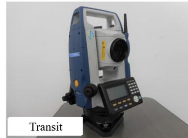
**[Transit]** Perangkat yang mengukur sudut vertikal dan horizontal dengan titik referensi yaitu sudut pandang yang menyangga teleskop kecil. Gunakan dengan menaikannya ke tripod. Saat ini, perangkat jenis tampilan digital yang disebut “theodolite” sering digunakan.
