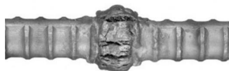
නරක ඉදිමීමකට උදාහරණයක්
