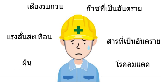
ภาพที่ 2-14 ปัจจัยที่เป็นอันตรายในไซต์งานก่อสร้าง
