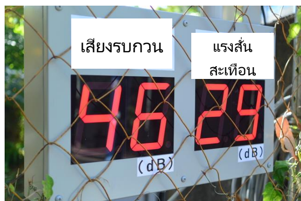
ภาพถ่ายที่ 2-2 ตัวอย่างการแสดงผลระดับเสียงรบกวนและแรงสั่นสะเทือน
