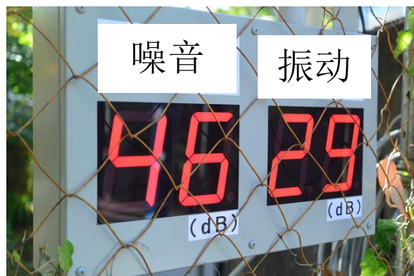
照片 2-2 显示噪音和振动数值的示意图
