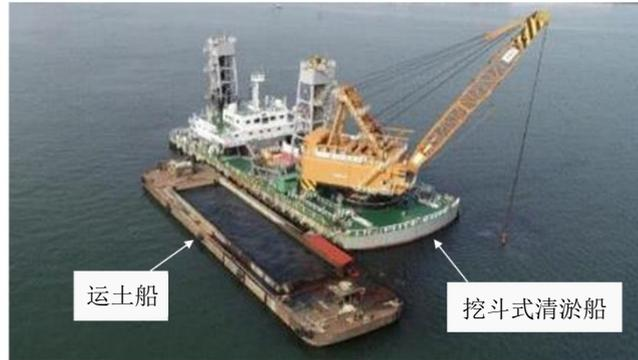
**[填海工程]**填埋沙土以造出新土地的工程称为填海工程。施工时通过船舶或机械将疏浚工程中清除的沙土运至施工场所，注入海中以形成土地。
