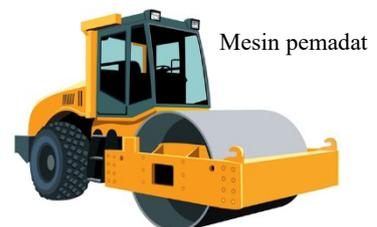
[**Mesin penggilas**] Mesin pemadat dengan roller besi. Mesin ini digunakan untuk memadatkan tanah dasar dan lapisan fondasi dalam pekerjaan perkerasan, dll.
