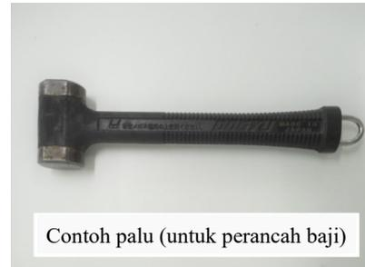
**[Palu karet]** Palu yang bagian pemukulnya terbuat dari karet. Palu ini memiliki karakteristik kekuatan tumbukan yang kuat dan tidak mudah merusak material. Pada pekerjaan pengecoran beton, palu karet digunakan untuk memadatkan beton dengan memukul bekisting dan memberikan getaran.
