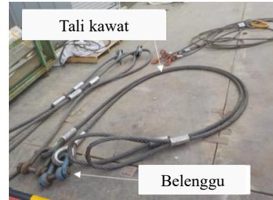
[**Belunggu**] Perlengkapan logam slinging untuk menyambungkan tali kawat atau rantai ke beban yang digantung.
