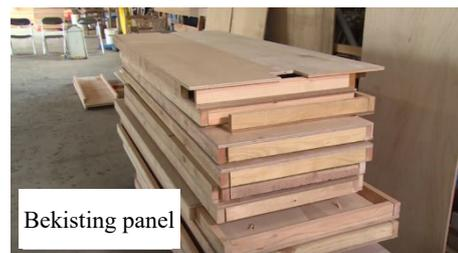
**[Batten]** Kayu berbentuk segi empat dengan lebar 90 mm atau 105 mm. Digunakan untuk menerima pipa tunggal bekisting lantai dan memasang penyangga pipa. Juga dapat digunakan sebagai alas untuk menaikkan benda berat.
