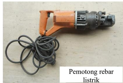
**[Pemotong rebar listrik]** Alat listrik yang menggunakan pompa hidrolik untuk menggerakkan bilah dan memotong rebar. Pegang rebar dengan ujungnya dan tekan bilahnya untuk memotong.
