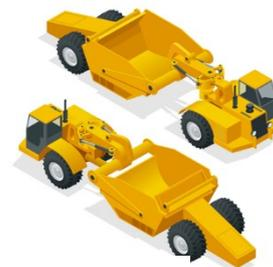
**[Motor scraper]** Ini adalah scraper yang dapat berjalan sendiri. Bilah yang mengikis tanah dan pasir dipasang di antara roda depan dan belakang, lalu tanah dan pasir yang dikikis dikirim ke wadah di atas bilah untuk memotong dan meratakan tanah.
