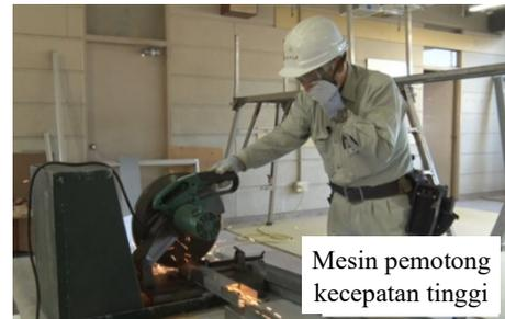
Mesin pemotong kecepatan tinggi
