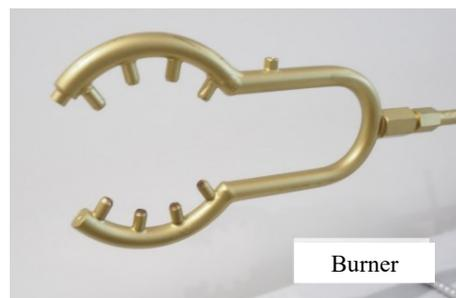
**[Blowpipe]** Alat pemanas untuk mencampur dan mengirimkan oksigen dan gas asetilena.
