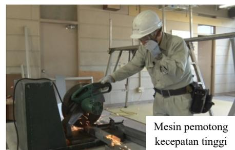
Mesin pemotong kecepatan tinggi
