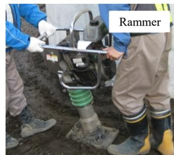
**[Rammer]** Mesin untuk memadatkan tanah. Pemadatan dilakukan oleh bobot rammer dan kekuatan pelat tumbukan yang bergerak naik turun. Rammer memiliki gaya tumbuk yang kuat dan cocok untuk pemadatan yang kuat. Ada rammer jenis mesin dan jenis listrik.
