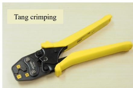
**[Terminal crimping]** Terminal untuk sambungan yang dipasang di ujung kabel listrik. Kencangkan kabel dengan menghancurkan kabel yang dimasukkan ke dalam lubang sambungan terminal crimping bersama dengan sambungan terminal crimping. Gunakan alat yang cocok untuk terminal crimping.
