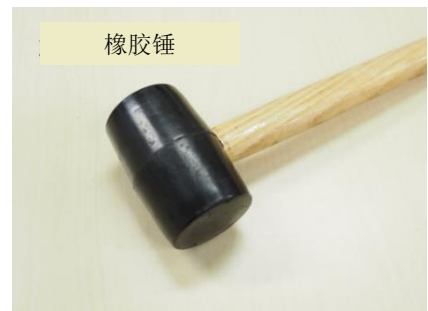
锤子示例（用于楔紧式脚手架）
