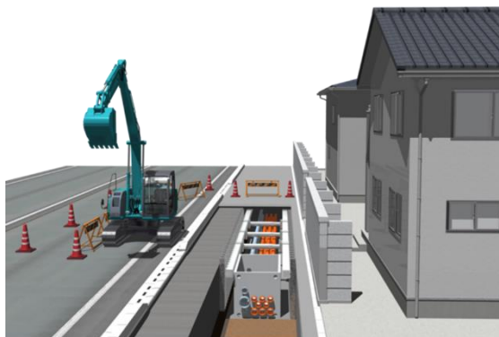
无电线杆工程
