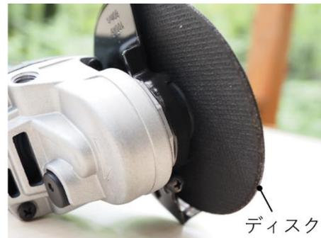
【サンダー】サンドペーパーを動かすことで、平らな面を磨くための電動工具です。サンドペーパーを動かす仕組みとしては、振動タイプ、ベルトタイプ、回転タイプなどがあります。
