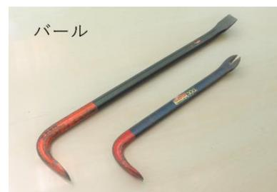
す。また、隙間に差し込んで、ねじる・こじる使い方もできます。型枠の解体作業では、大バールが使われます。
