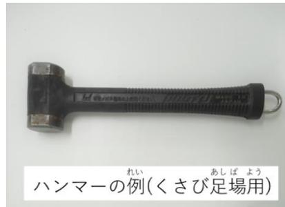
【ゴムハンマー】叩く部分がゴムでできているハンマーです。打撃力が強く、材料にも傷をつけにくいという特長があります。コンクリートの打設作業では、型枠を叩き振動を与えることでコンクリートを締め固めるときに使われます。
