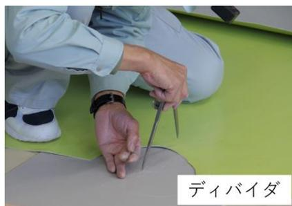
【ディバイダ】<sup>に</sup>コンパスと似<sup>りょうほう</sup>ていますが、両方<sup>あし</sup>の脚<sup>はり</sup>に針<sup>つ</sup>が付<sup>おな</sup>け<sup>なが</sup>られて<sup>べつ</sup>います。同じ長さ<sup>ぶぶん</sup>を別の部分<sup>ざいりょう</sup>や<sup>うつ</sup> <sup>もくてき</sup> <sup>つか</sup> <sup>材</sup> <sup>料</sup> <sup>に</sup> <sup>移</sup> <sup>す</sup> <sup>目</sup> <sup>的</sup> <sup>で</sup> <sup>使</sup> <sup>わ</sup> <sup>れ</sup> <sup>ま</sup> <sup>す</sup>。
