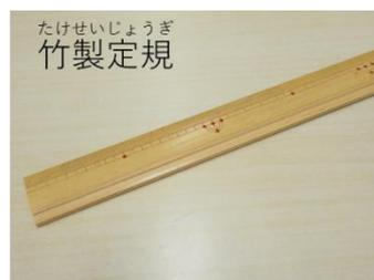
【スランプ検尺】スランプ試験における、スランプ値（スランプコーンを外したことによって低くなった分の高さ）を測るための器具です。
