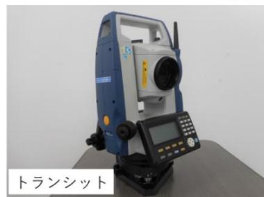
【トランシット】小型の望遠鏡を支える視点を基点として上下方向、水平方向の角度を測定する機器です。
